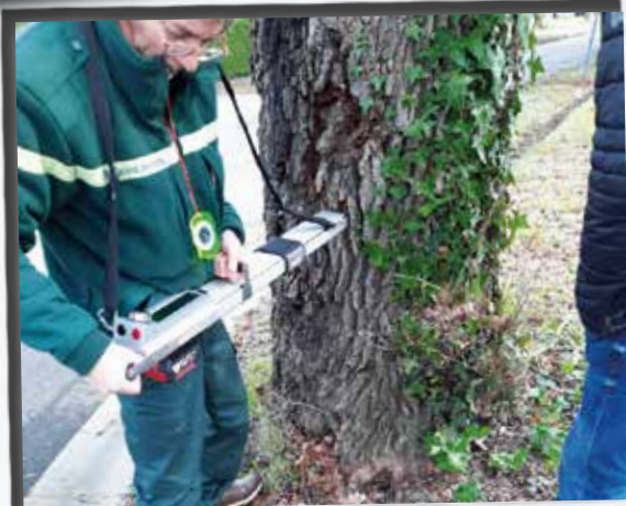
Les experts de l'ONF mesurent la densité du bois à l'intérieur du tronc avec un pénétromètre.
